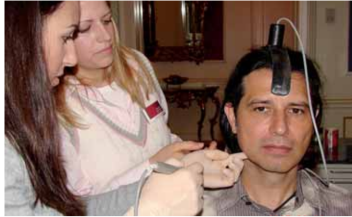
Im Rahmen eines Kurses wird die Anwendung des noXrayCeph-Systems® geübt. Der Patient (in diesem Falle Dr. Seiferth, in dessen Praxis die Fortbildung stattfand) trägt den Cephostat während der Messung auf dem Kopf. Dieser enthält drei Empfänger-Spulen, welche das Signal des Mess-Stiftes empfangen und seine räumliche Position orten. Die Software zeigt dem Anwender dann über die Sprachausgabe die 55 Bezugspunkte inner- und außerhalb des Mundes, an die dieser den Messstift führen muss. (Foto: Brandt)
